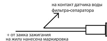
Примерная схема подключения нагревателя сепаратора REDLINE к бортовой сети.
